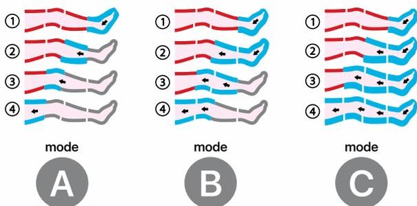
**MODE A:** la sequenza del programma prevede il gonfiaggio e lo sgonfiaggio del gambale un settore per volta, per effettuare un massaggio attivante, ideale prima della gara o dell'allenamento.
